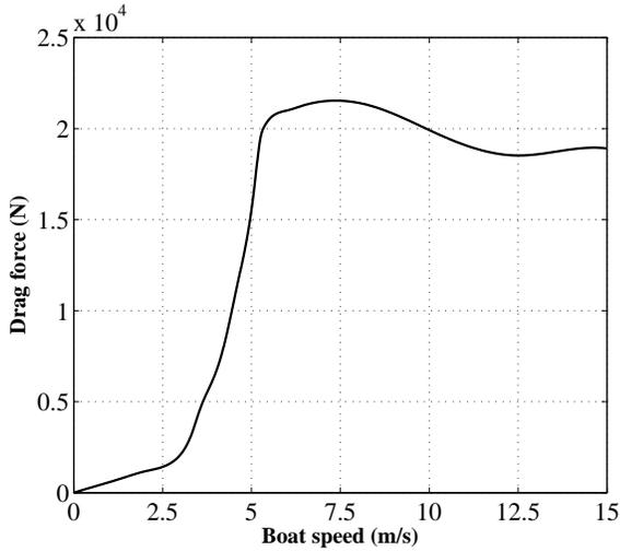
Fig. 6. Boat drag force  $F^{\text{R}}(v)$
